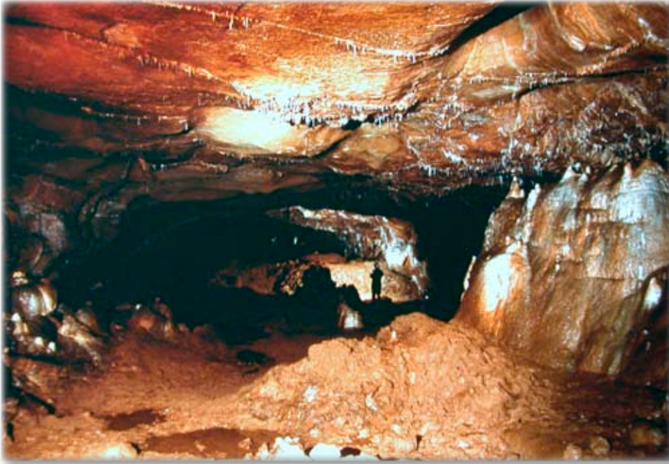
Fig. 6. Grotte-mine des Equevillons à Montcey, Haute-Saône. Paysage souterrain karstique remodelé par l'exploitation minière. Au premier plan, haldes correspondant au fonçage d'un puits dans le remplissage karstique sous-jacent. Le plancher stalagmitique est utilisé comme voie de roulage et comme aire de tri. Cliché © D. Morin.
