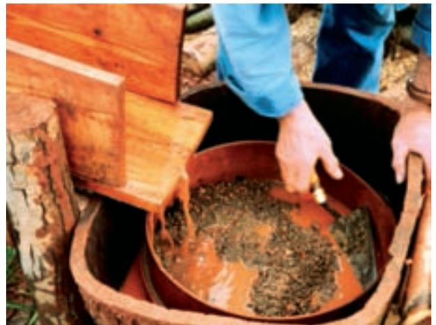
Expérimentation du lavage de minerai de fer dans un lavoir à bras avec criblage dans un tamis.
